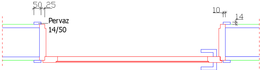
Şekil 3.10: Kapı pervazlarının çizilmesi
