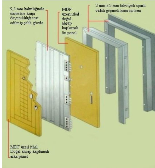
Resim 3.8: Çelik kapı kasa ve kanat elemanları
